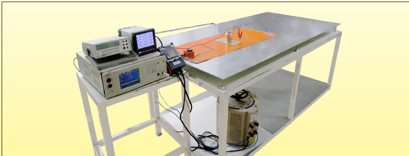
Измерительное оборудование для измерения полного тока утечки в горячем состоянии
